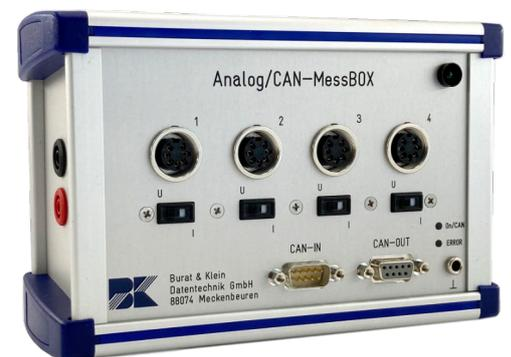
Die **Analog/CAN-MessBOX** kann für aktiven analogen Sensoren (0/4 ... 20 mA bzw.  $\pm 10$  V (mit Adapterkabel bis 30 V) verwendet werden. Ein Analogumschalter pro Port ermöglicht auf allen 4 Kanälen unabhängige Strom und Spannungsmessungen.
