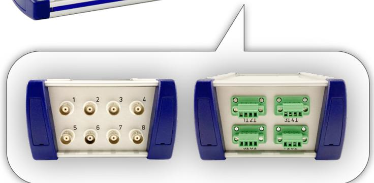
Die DG - MessBOX erfasst dynamisch 8 digitale Signale und dient als Erweiterungsmodul für TeleInspektoren® oder MiniMessBOXen.
